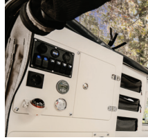
Kontrol paneli ve 220 V priz
